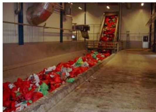
Sol de stockage et de transport installé dans une fosse en béton.
