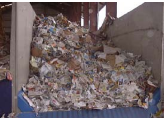
Sol de stockage et de transport autonome combiné avec une structure de murs en béton.
