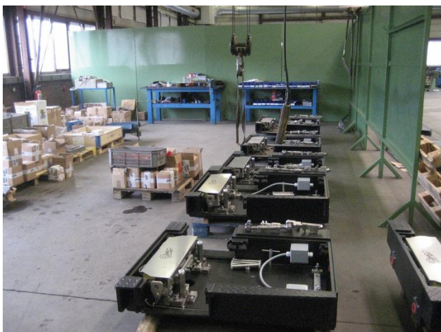
Assemblage van Spirorail® tram wisselsters t.b.v. Amsterdamse tram.
